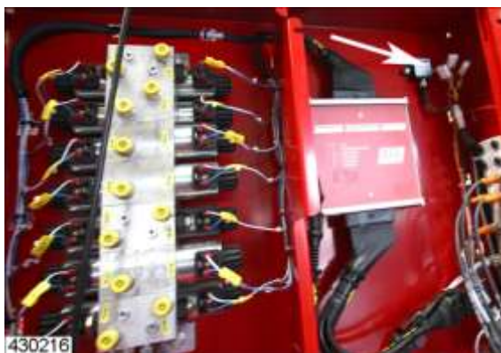
Stekker voor de aansluiting van de werklampen X-AB1 en X-AB2 (3)
