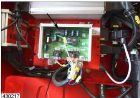
Relais K2 (1) op printplaat Vlakstekker AB 1 (2)
